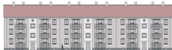
Südansicht Collegienstr. 4-6 nach Hül-lensanierung und Balkonanbau
