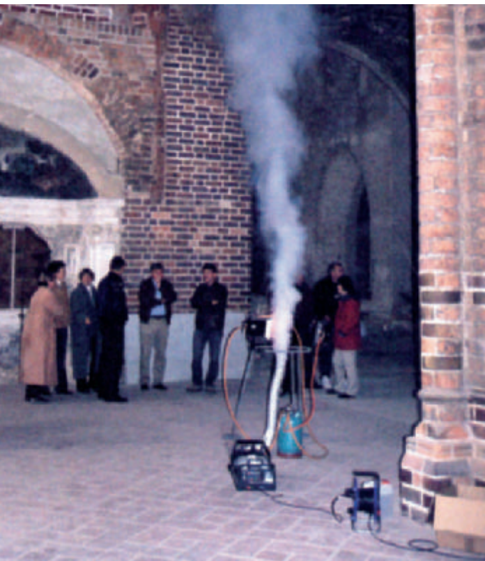
Rauchzeichen? - hier wird der Rauchabzug in der Kirche getestet
